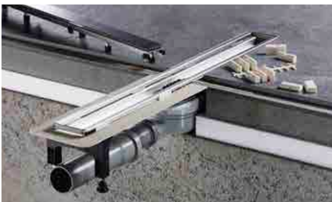
Paralelno vođenje ispod kanalice osigurava da priključna cijev ne prođe kroz estrih.
